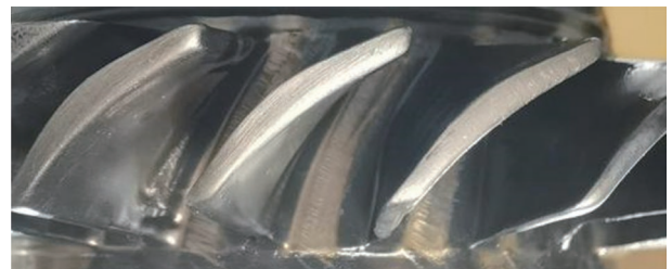
图2 旋转套料加工后的整体叶盘叶片
